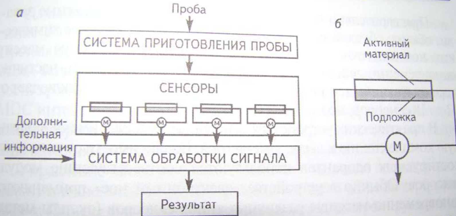
Рис. 4.23. Схема «электронного носа» [139]: a — общая схема; б — схема сенсора; электрическая цепь включает сенсор (в большинстве случаев является двухслойным — состоит из подложки и активного материала, дающего специфический ответ при появлении анализируемой примеси) и счетчик (М) для измерения изменения характеристики сенсора.
